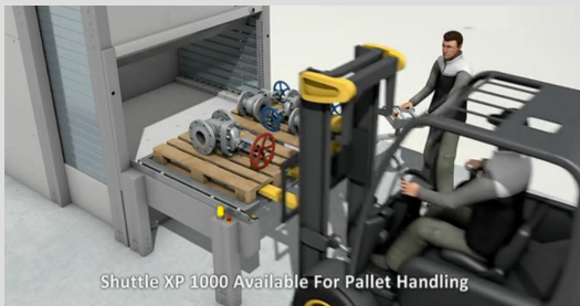
XP1000型号,叉车直接整栈叉进叉出,
